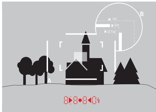
Alle Aufnahmen und Leuchtrahmen-Positionen bezogen auf 50mm Brennweite
